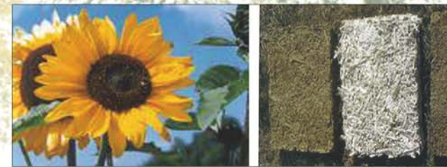
AGRO MATÉRIAUX BRIQUES ISOLANTES RÉALISÉES À PARTIR DE BROYAT DE TOURNESOL (6)
