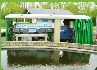
Unité mobile de centrifugation des boues
