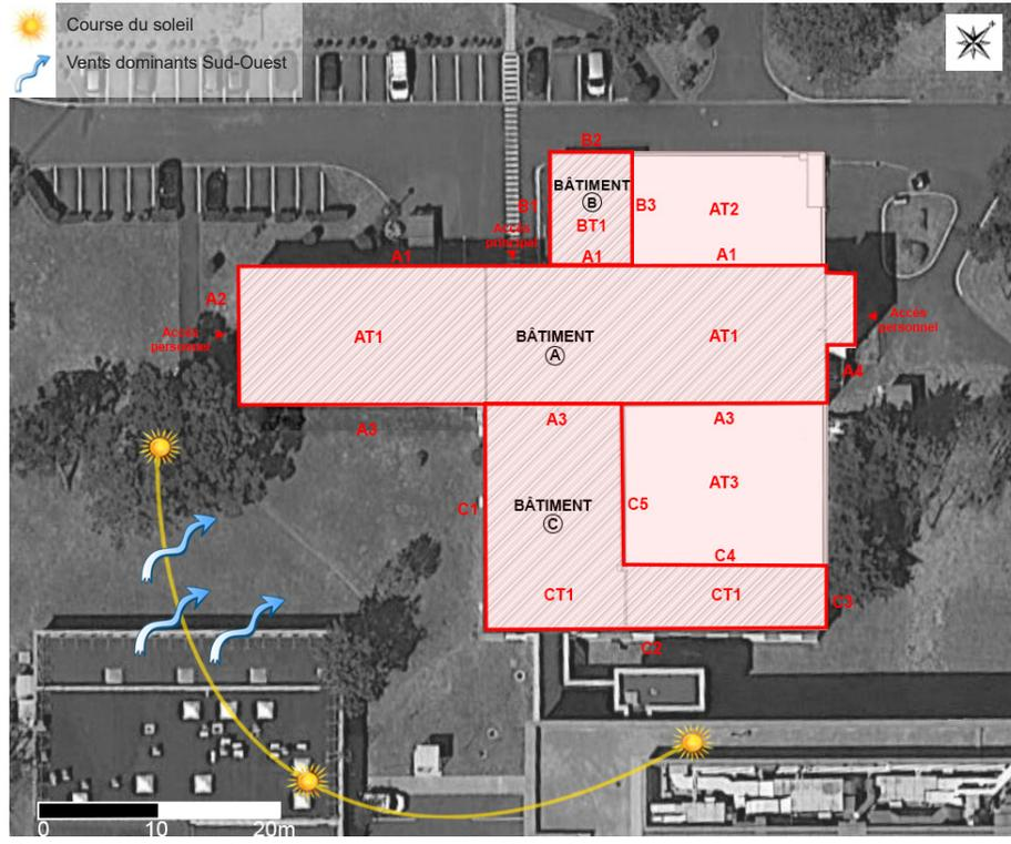
Plan masse Bioclimatique de l'ensemble des bâtiments
