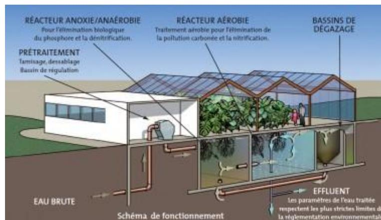
Figure 51 : Schéma de fonctionnement d'une station d'épuration Organica®
