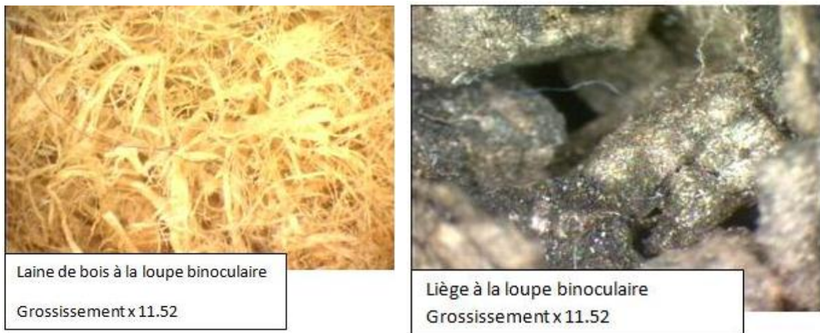
Figure 8 : Observation au microscope optique du volume d'air dans deux isolants
