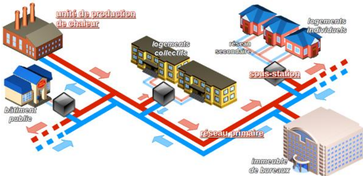
Figure 42 : Schéma de réseaux de distribution de chaleur
